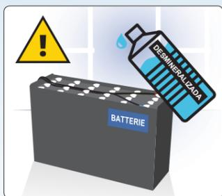
Uma bateria só pode ser abastecida com água desmineralizada e após o carregamento.
