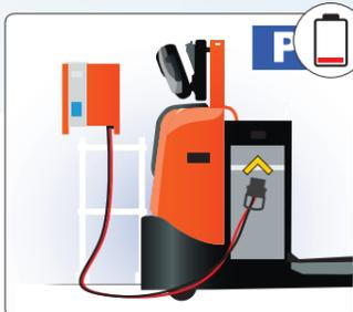
Posicione o empilhador no lugar designado, desligue-o e conecte o carregador com a bateria.
