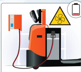
Assegure a ventilação adequada deixando o compartimento da bateria aberto, caso esta permaneça no empilhador.
